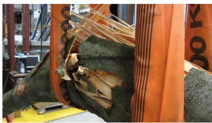
Biegeversuch am frisch geschlagenen Schaft einer Rotbuche im Institut für Bauforschung
