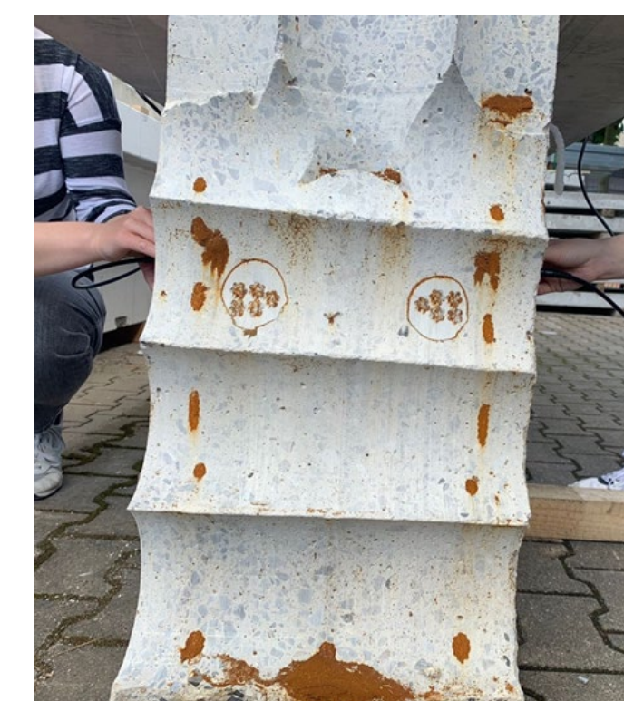
Abbildung 6: Prüfprozess Rückprallhammer und Ultraschall-Transmission
