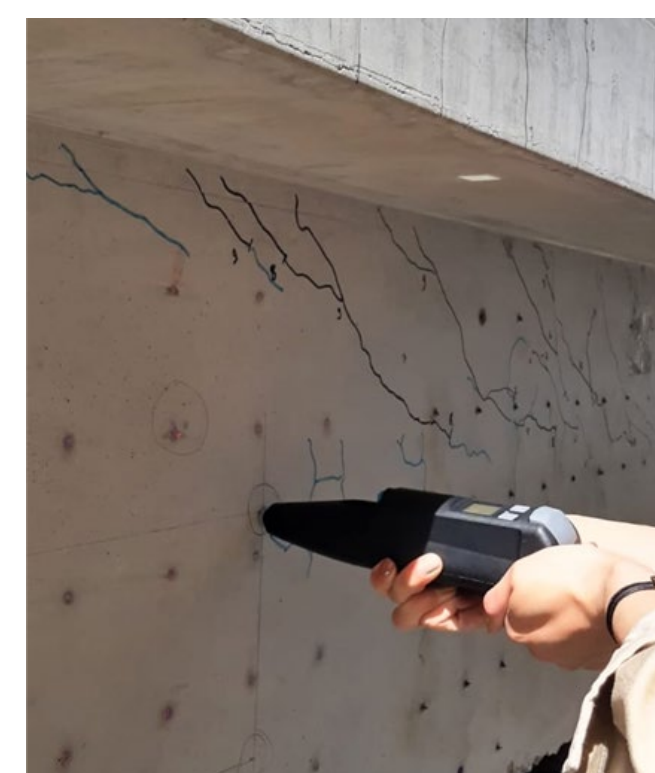
Abbildung 6: Prüfprozess Rückprallhammer und Ultraschall-Transmission
